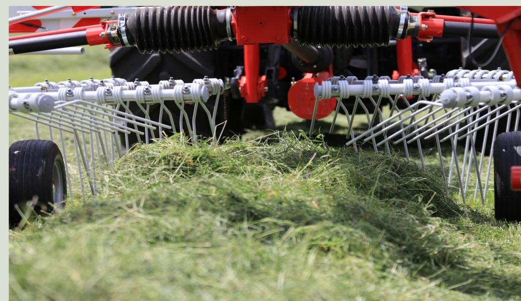
La larghezza dell'andana va adattata a quella di lavoro del pick-up destinato alla raccolta. L'ideale è un'andana a sezione trapezoidale con bordi marcatamente inclinati. Se l'inclinazione è insufficiente, le ruote del trattore possono schiacciare il foraggio, che non potrà più essere raccolto.
