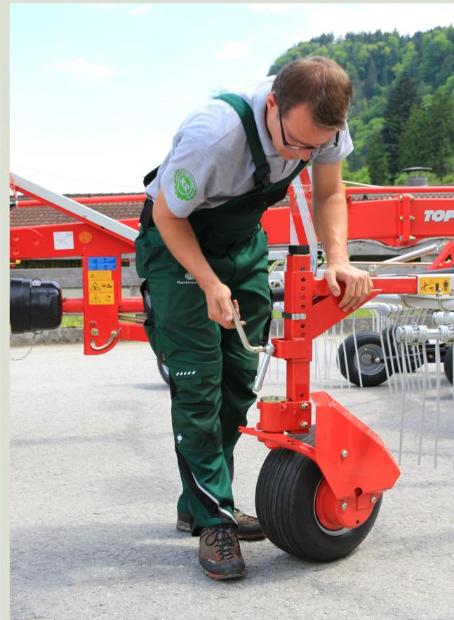
La regolazione dell'altezza di lavorazione del ranghinatore a due rotori è analoga a quella descritta per il ranghinatore a rotore singolo.
