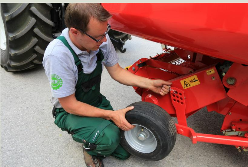
La distanza del pick-up dalla superficie del suolo si regola agendo sulle ruote d'appoggio laterali del pick-up (a volte queste ruote sono posizionate posteriormente al pick-up). I denti devono trovarsi a circa 3 cm dal suolo. La regolazione va fatta su una superficie solida e orizzontale.
