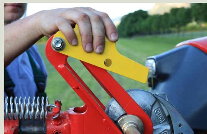
Per il trasporto su strada il telaio articolato e il terzo punto vanno entrambi bloccati. Di solito, si interviene in questo senso con apposite leve di bloccaggio o riposizionando delle coppie.
