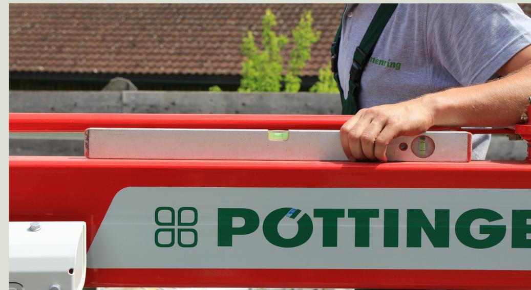
Rispetto al ranghinatore a singolo rotore, l'orizzontalità del telaio deve essere perfetta per fare in modo che la cinematica dei rotori assicuri una lavorazione del foraggio ideale. Questa regolazione si esegue tramite il sollevatore del trattore.
