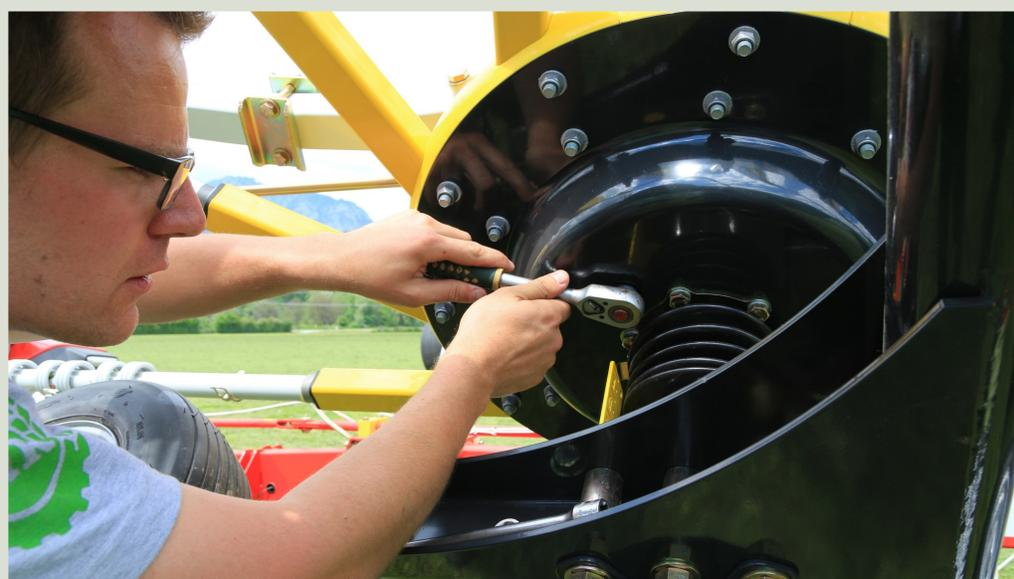
Una camma regolabile consente di modificare la forma dell'andana. Se l'inclinazione dei bordi è insufficiente, basta ruotare la camma per far sì che i denti si disinseriscano un po' più tardi, spostando il foraggio un po' più lontano, verso il centro dell'andana.
