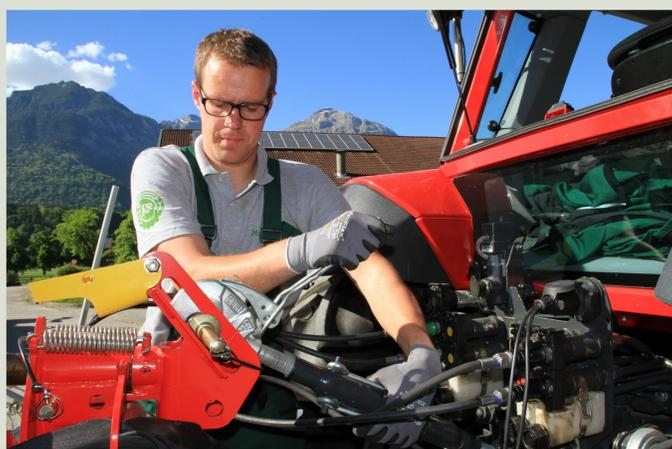
La lunghezza del terzo punto deve consentire allo spandifieno di oscillare liberamente in senso verticale (fissaggio al centro del foro ovale). Se manca la ruota d'appoggio, l'altezza si regola agendo sulla lunghezza del terzo punto, fissato, in questo caso, nel foro circolare.
