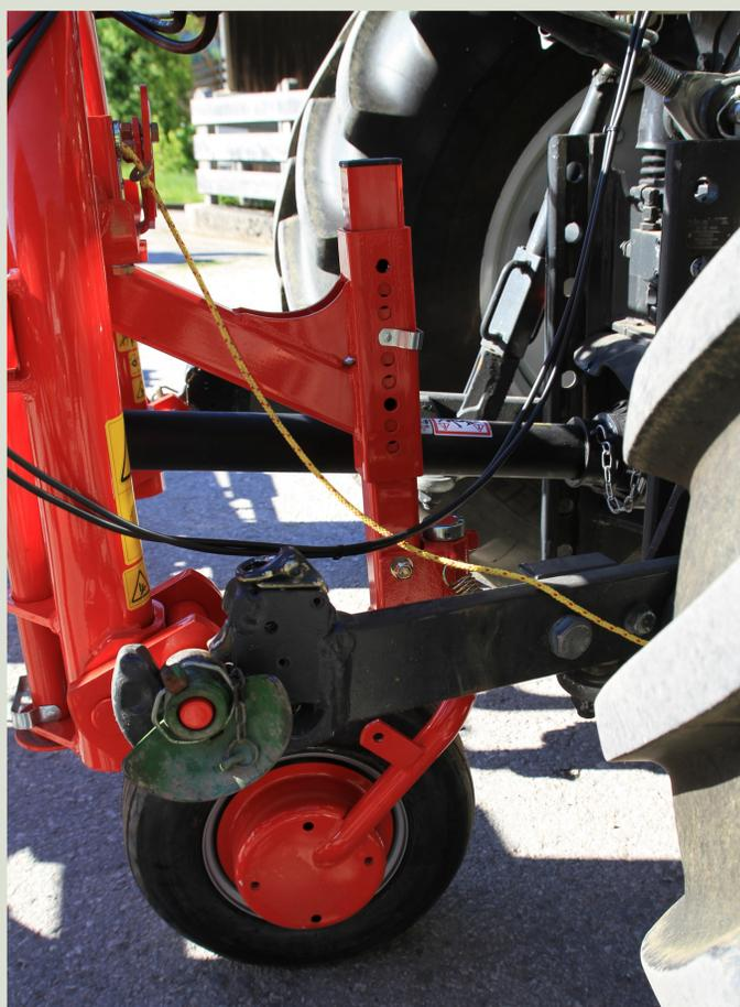
Se lo spandifieno è dotato di una ruota d'appoggio, l'altezza dei denti si regola agendo sui fori della relativa slitta di regolazione. In questo caso, il terzo punto deve essere mobile o va usata un'apposita catena. La regolazione va eseguita su una superficie solida e orizzontale.
