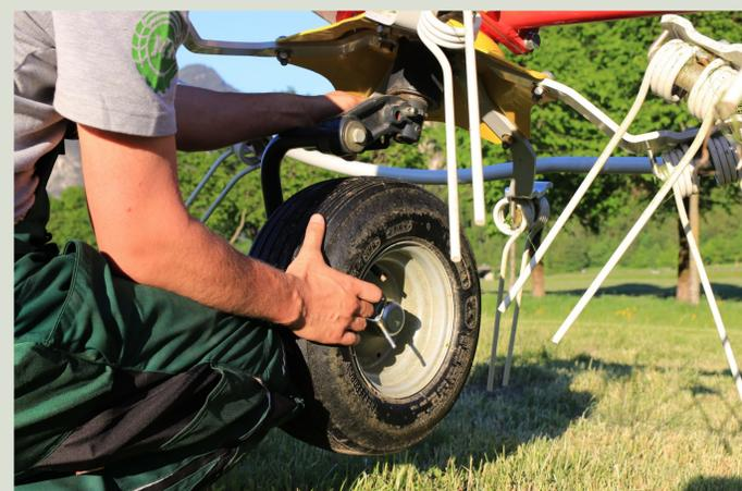
Per ottimizzare lo spargimento del foraggio, si può regolare l'angolo d'incidenza dei denti agendo sulle ruote. La regolazione dipende dalla quantità e dal grado d'essiccazione del foraggio. Se necessario, correggere l'altezza di lavoro.
