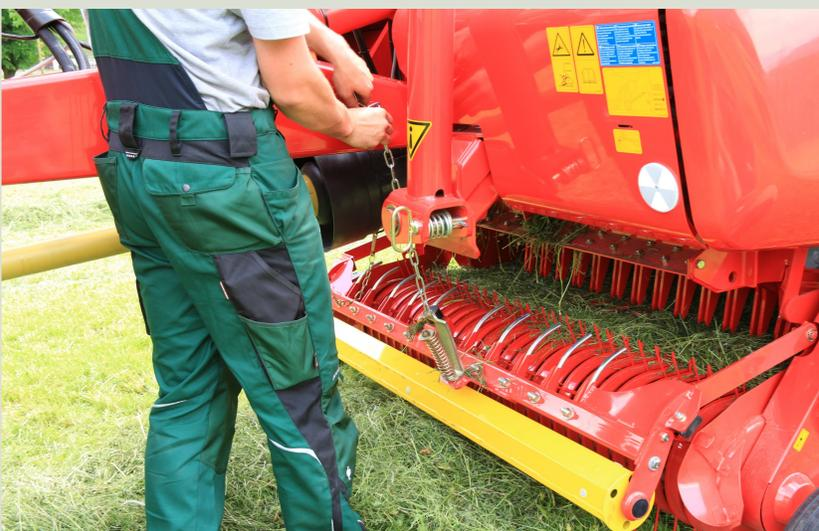
L'altezza del rullo convogliatore va regolata in funzione della quantità di foraggio presente, in modo da assicurare un flusso regolare di foraggio verso il pick-up. Se il rullo è troppo alto rispetto alla massa foraggera, il foraggio viene spinto in avanti invece di essere raccolto.
