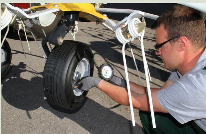
Prima di iniziare, bisogna controllare il fissaggio, l'angolo d'incidenza e i cavetti di sicurezza dei denti, nonché la pressione degli pneumatici.
