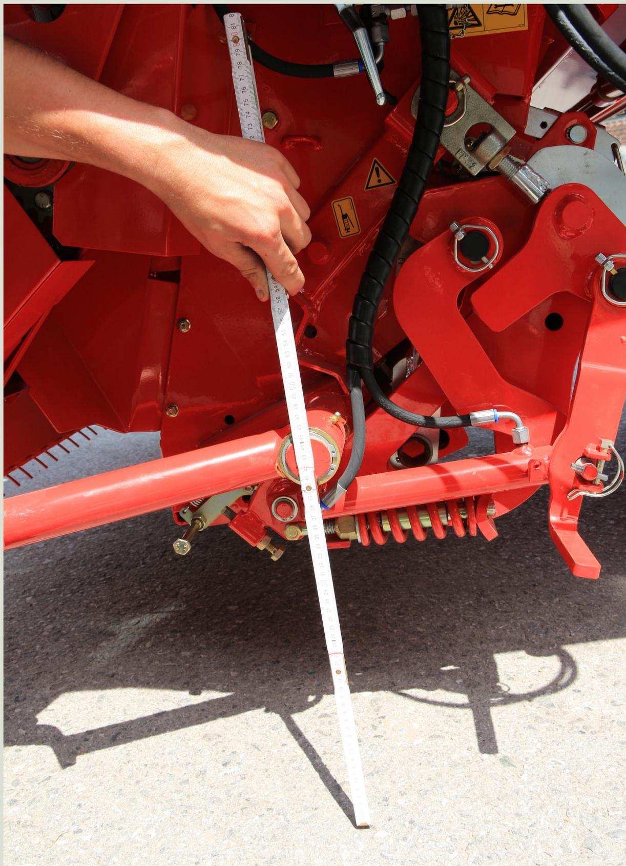
Per potersi adattare alle irregolarità del suolo, il pick-up deve avere una mobilità verticale sufficiente, che, a sua volta, dipende dall'altezza del gancio d'accoppiamento al trattore. Osservare le istruzioni del fabbricante (manuale d'istruzione e/o etichette presenti sul telaio)!
