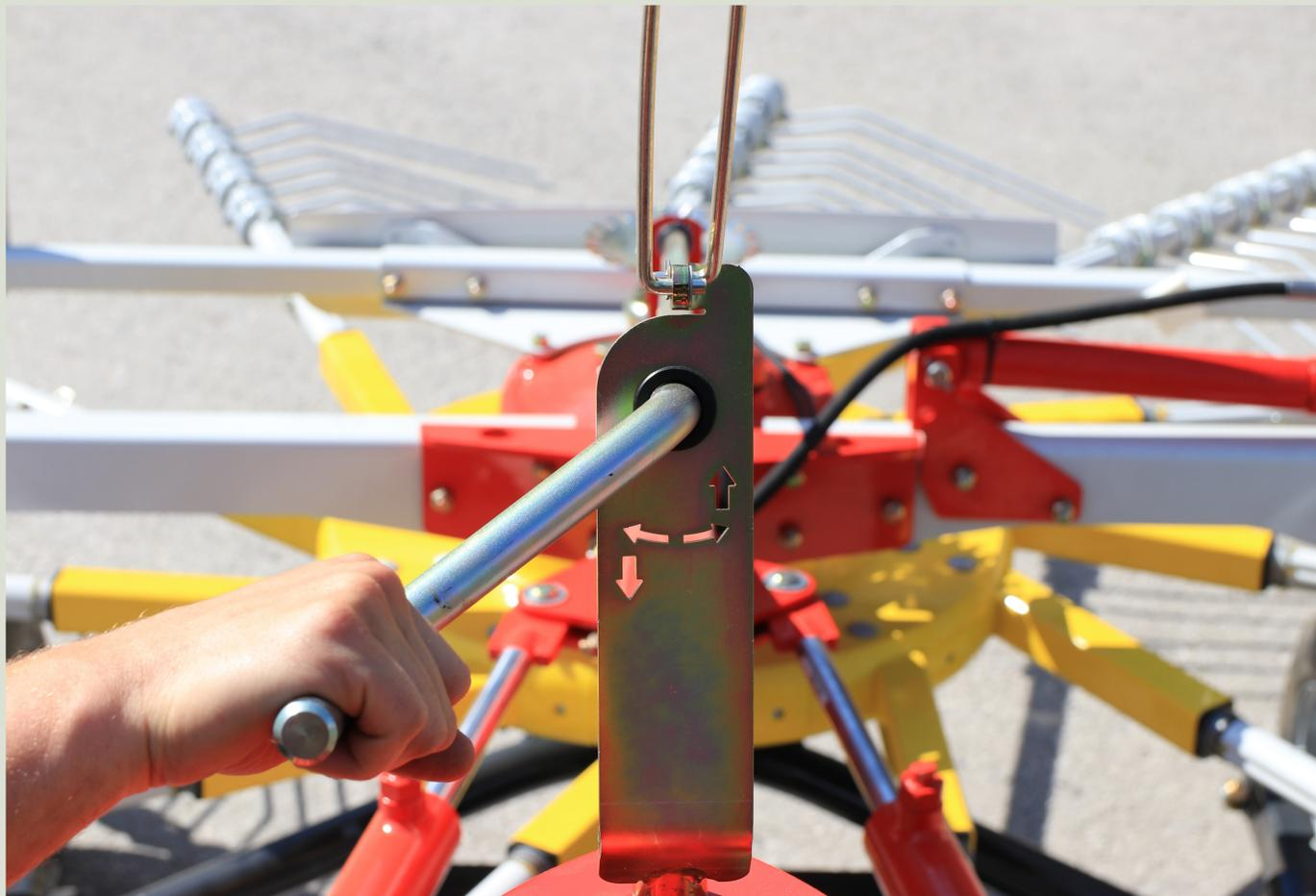
Una volta regolata la ruota d'appoggio, si interviene sulla vite senza fine per fare in modo che la macchina lavori in posizione orizzontale e per regolare con precisione l'altezza dei denti.
