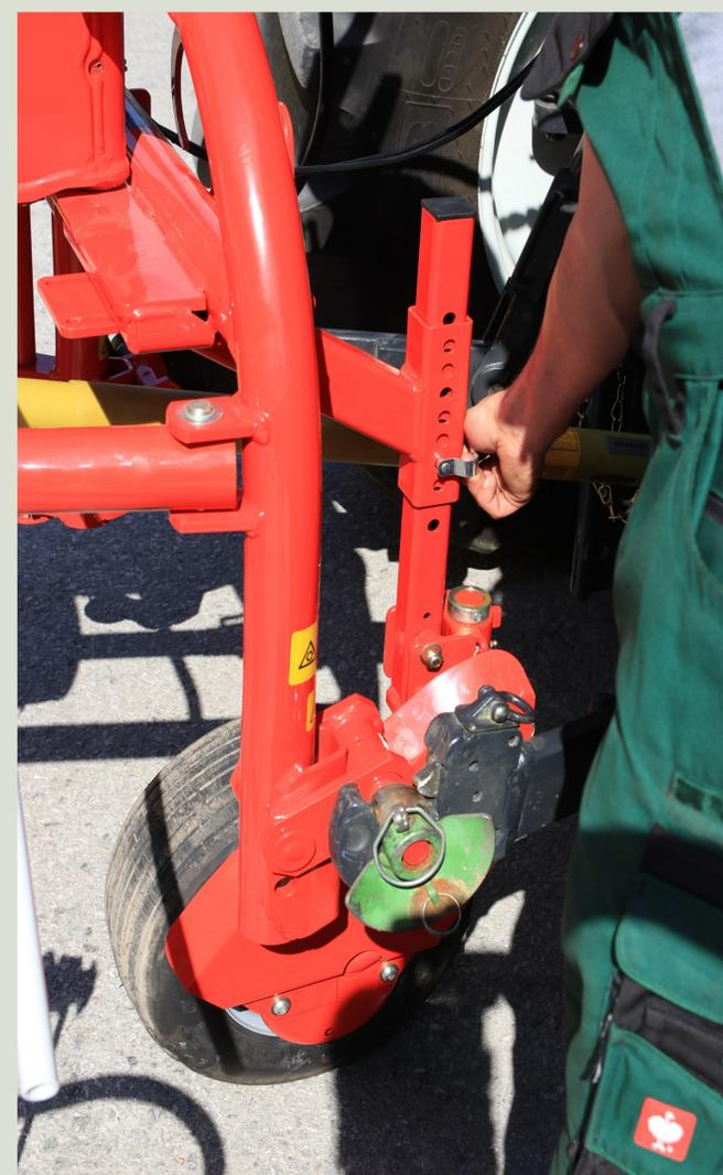
Come nel caso dello spandifieno, l'altezza dei denti si regola agendo sui fori della slitta di regolazione della ruota d'appoggio. La regolazione va eseguita su una superficie solida e orizzontale. La distanza dei denti dal suolo si controlla anteriormente, vicino alla ruota d'appoggio.
