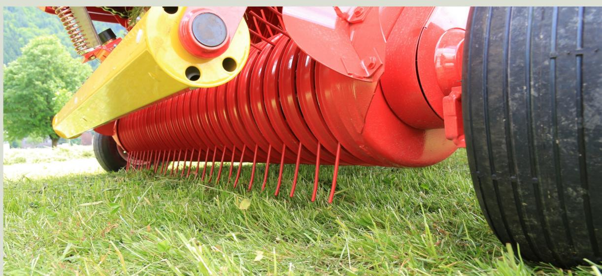
Una volta in campo, bisogna verificare, in assenza di foraggio, che i denti del pick-up non tocchino la superficie del suolo.
