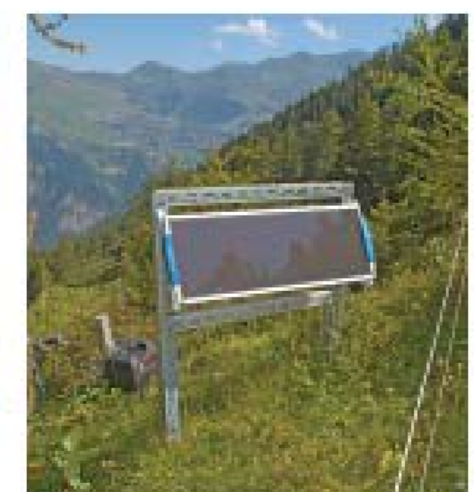
Pastore elettrico a batteria alimentato da un pannello fotovoltaico. In condizioni d'esercizio, la tensione è di circa 6 kV. Fotografia: Agroscope/CW.
